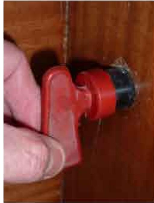
Enlever le commutateur, clé rouge, déposer sur le tableau de bord
